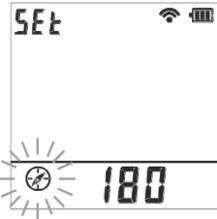
Wechseln Sie mit der Taste
