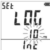
Ändern des Aufzeichnungsintervalls. Verwenden Sie die Tasten
