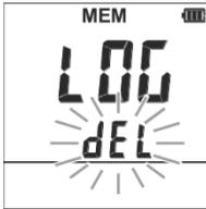
4 Drücken Sie
