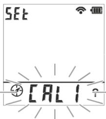
Verwenden Sie die Taste
