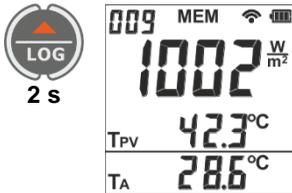
Verwenden Sie die Schaltfläche
